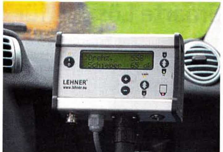
Überwachung: Der Bedienmonitor des Streuers Polaro E liefert Informationen zur Dosierung und zum Füllstand.
