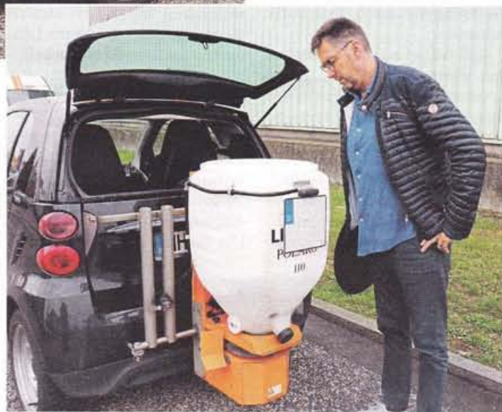
Leichtgewicht: Der Kunststoffbehälter des Lehner-Streuers Polaro E fasst 110 Liter und wird mit Blähton befüllt.
