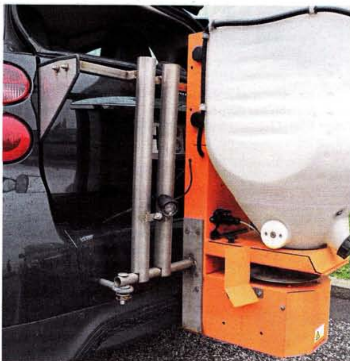
Sicher im Rohr: Am Tragegestell des Lehner-Streuers bieten zwei senkrecht aufgeschweißte Rohre Platz für einen zusätzlichen Handschneeschieber und einen Besen.
